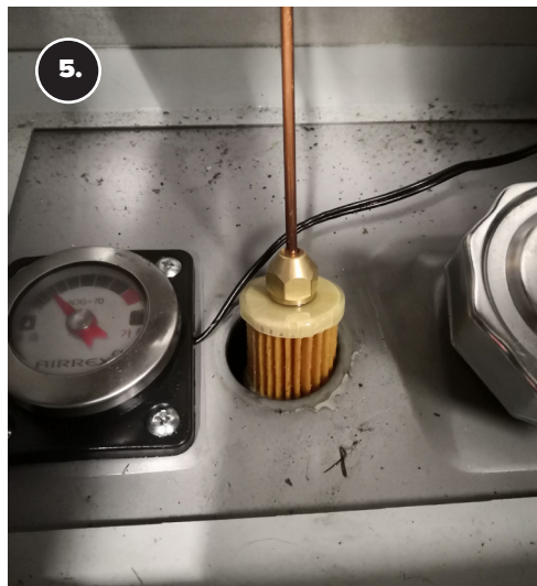
Polttoainesuodatin nousee kupariputken mukana. Valuta suodatinta hetki suodatinreiässä, ettei polttoainetta valu ympäri konehuonetta.
