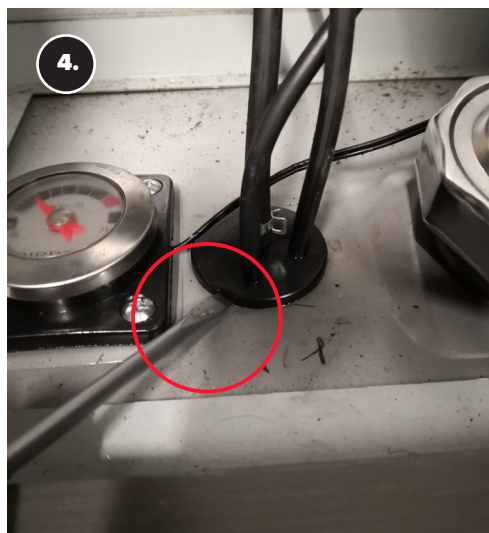
Lossa genomföringsgummit med en skruvmejsel och lyft upp gummit.
